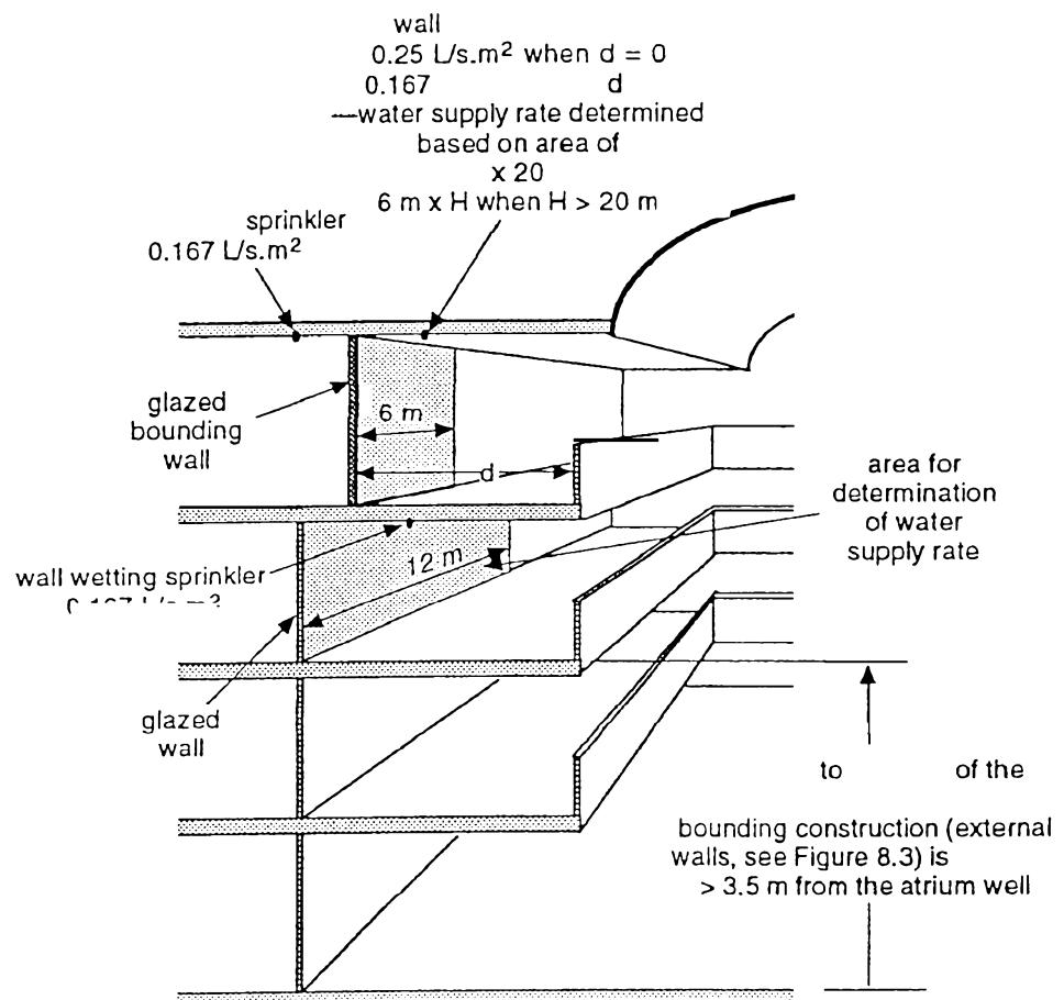
FIGURE 8.5 SPRINKLER REQUIREMENTS FOR GLAZED WALLS
