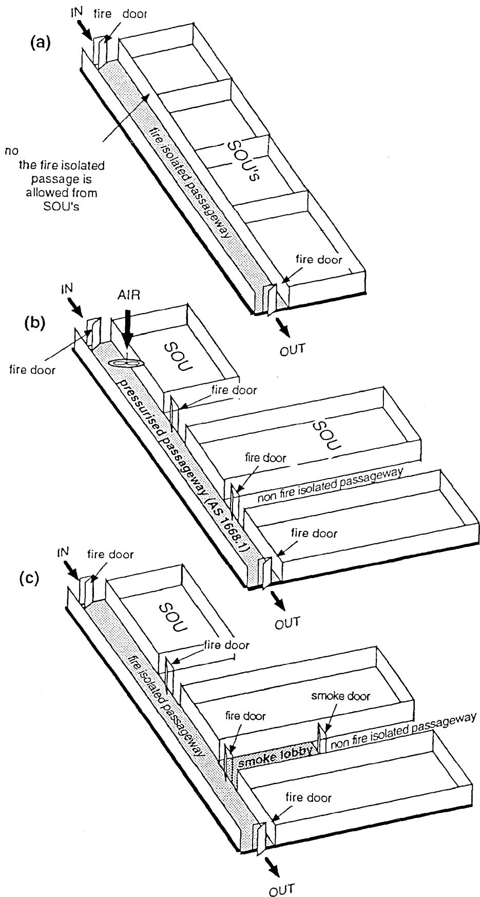
FIGURE 5.4 FIRE ISOLATED EXITS
