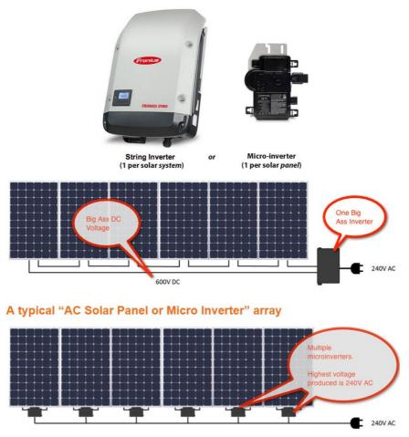
Figure 32: Microinverter<sup>28</sup>
